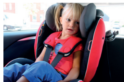
Le siège-enfant n'est pas correctement fixé au véhicule
